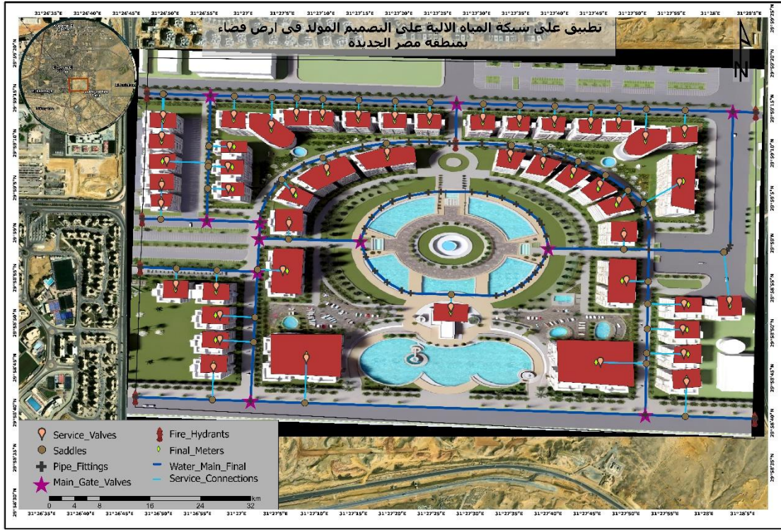
شكل (8-8): شبكة مياه الشرب المُصمَّمة آلياً — الحي الدائري بمصر الجديدة
