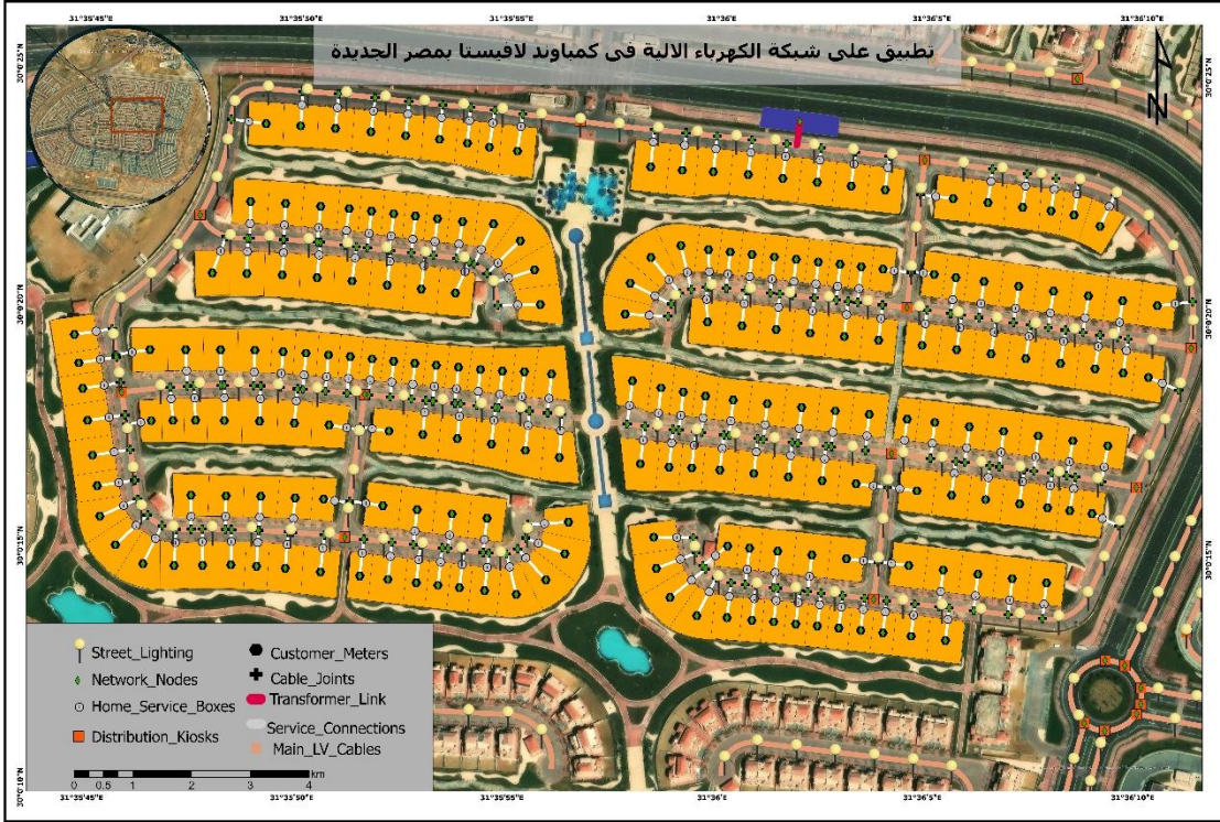
شكل (8-6): شبكة الكهرباء منخفضة الجهد المُصمَّمة آلياً لكمباوند لافيسنا — الكابلات والكشكات والإنارة
